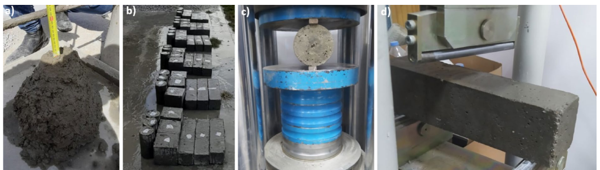
Fig. 7. Testing: (a) Slump test, (b) test specimen, (c) ST test, (d) FS test instances.
