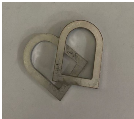
Fig. 2. Hollow semi-stadium fins (HSSF) structure.
